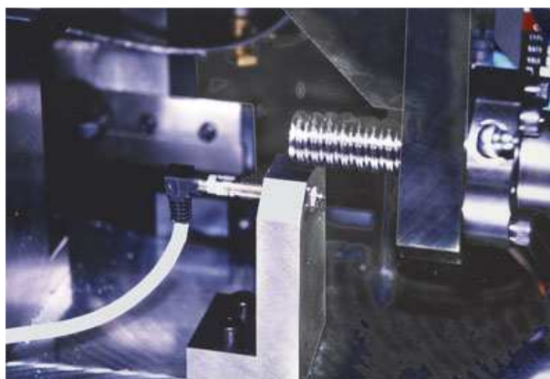
Le commutateur My-Com utilisé sur une décolleteuse pour de petites pièces
