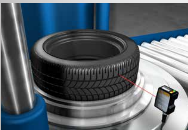
Inspektion von Reifen in der Produktion (schwarze Oberflächen) Die Überprüfung der Reifengeometrie, d. h. Messung der radialen und lateralen Unwucht, sowie Inspektion der Seitenwände auf Beulen, Einschnürungen, Dellen usw. erfolgt am Ende des Herstellungsprozess.
