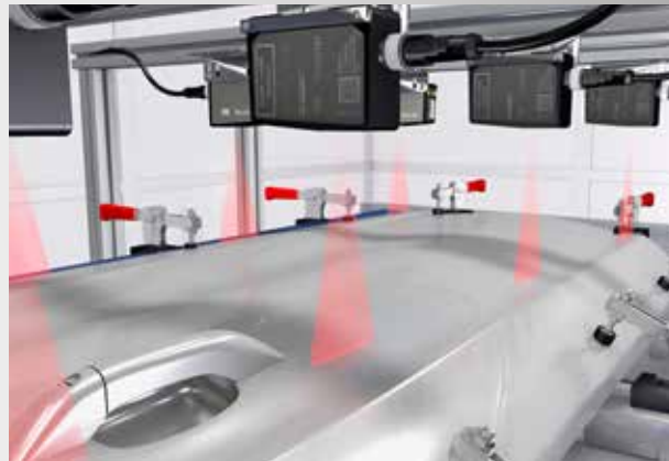
Formkontrolle von glänzenden Metallteilen Die breite Laserlinie des OM70 multi-spot ermöglicht die Formkontrolle durch präzise Messergebnisse auf glänzende Metallteile wie z. B. Autoteilen.
