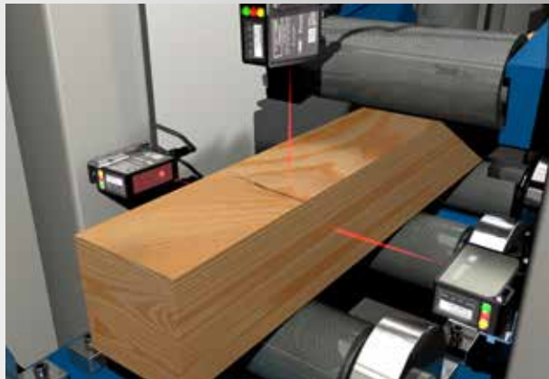
Dimensionskontrolle von Holzbalken (stark strukturierte Oberflächen) In der Holzverarbeitung überprüft der OM70 laser line die Masshaltigkeit von verleimten Brettschichthölzern, um die geforderte statische Belastbarkeit des Balkens sicherzustellen.
