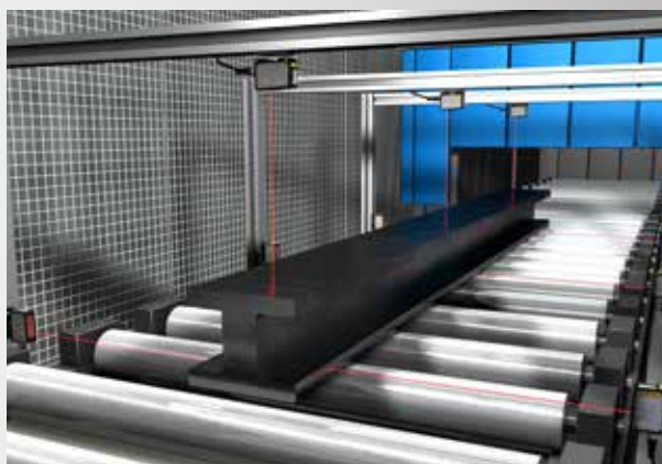
Détection de gauchissements sur les poutres en acier L'analyse de mesures simultanées sur une poutre en acier permet de détecter des gauchissements en toute fiabilité. La grande plage de mesure permet de mesurer différentes formes et tailles.
