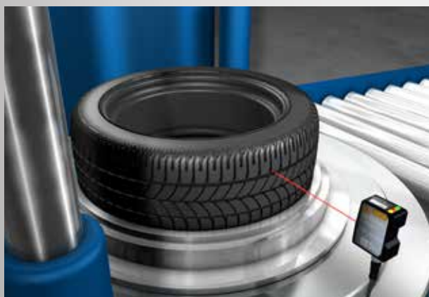
Inspection de pneus en production Le contrôle de la géométrie des pneus, c'est-à-dire la mesure du déséquilibre radial et latéral, ainsi que l'inspection des parois latérales pour détecter d'éventuelles hernies, rétrécissement, bosses etc. est réalisé à la fin du processus de fabrication.
