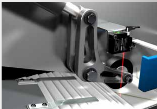
Alimentation en matière dans l'industrie graphique L'alimentation en enveloppes est régulée par une mesure exacte de la hauteur pour garantir le déroulement sans problème du processus.
