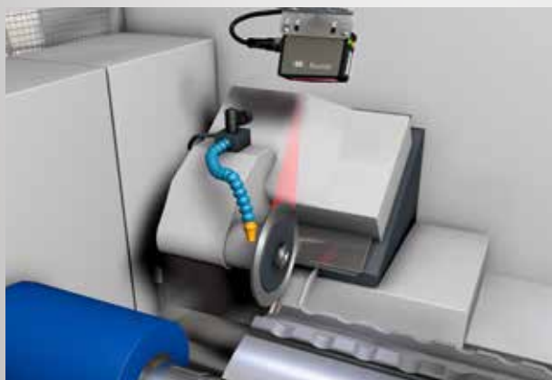
Mesure du diamètre d'un disque de meulage Grâce au calcul automatique de la valeur moyenne, les capteurs OM70 multi-spot permettent le positionnement optimal de disques de meulage très rugueux par rapport à une pièce à usiner.
